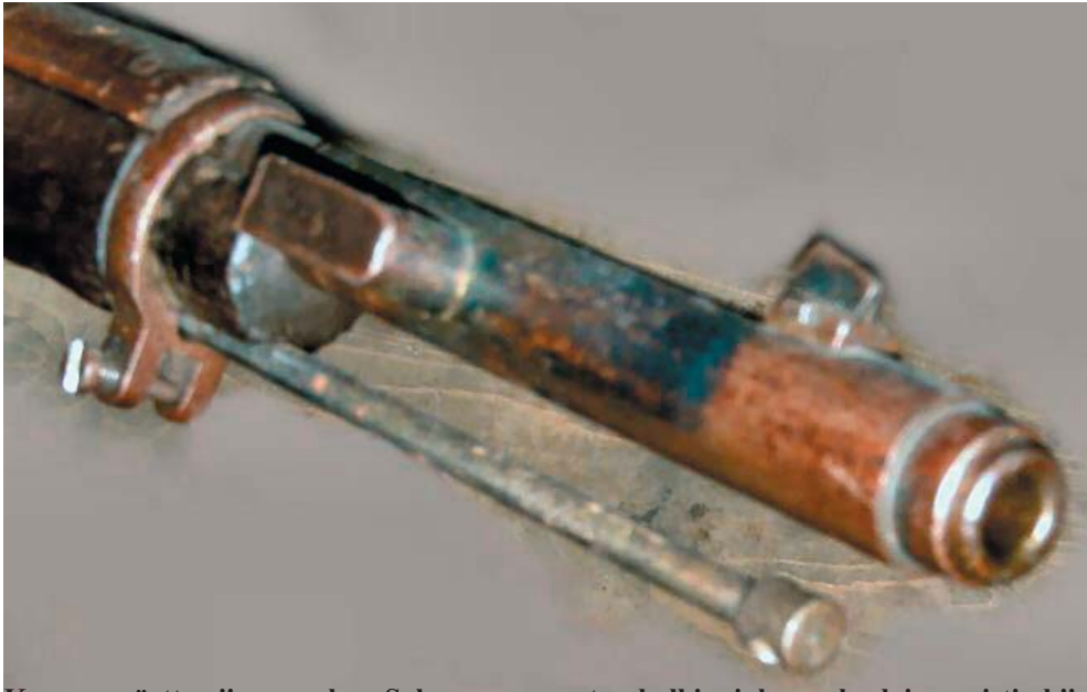
Kuvassa näette piipunsuuhun Saksassa asennetun holkin, johon saksalainen pistin kiinnitettiin.
