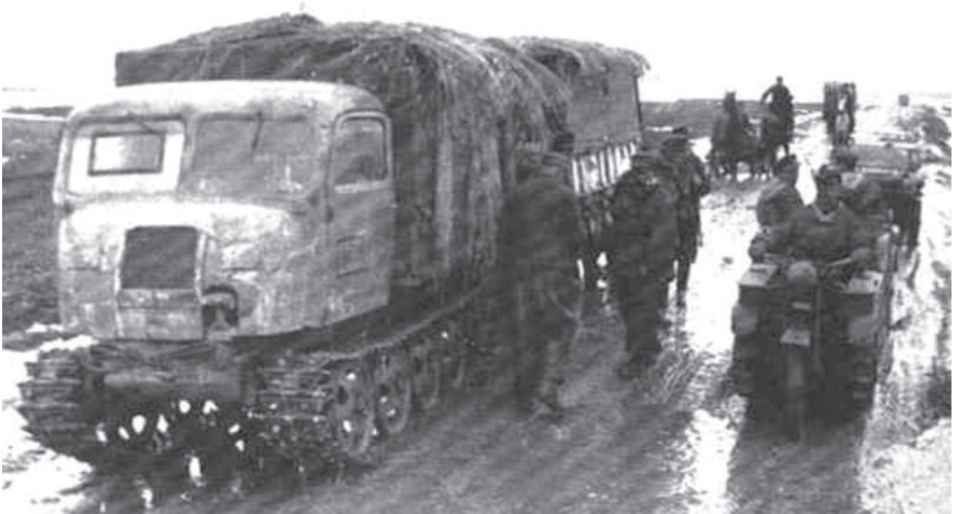
Kuvassa itärintaman olosuhteisiin kehitettyjä ajoneuvoja. Vasemmalla RSO-01 ja oikealla kaksi mainiota NSU-Kettenrad-telaketjumoottoripyörää. Huomaa kontrastina hevoset taustalla
