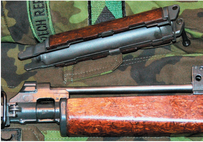
Ei kaasumännän suoja putkea
