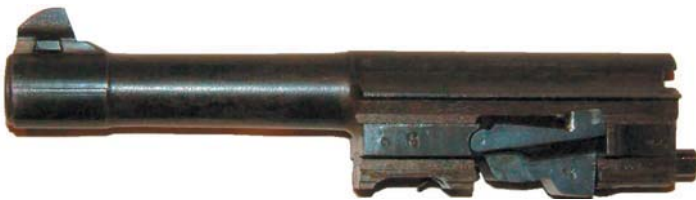
Sulkukappaleen edessä näkyy heikko leima 88 eli piipun valmistaja on Spreewerke
